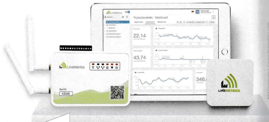
01: Beispiel für ein IOT Tool für einfache Zähleranwendungen mit mobiler Datenanalyse
