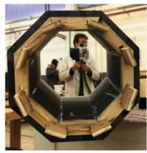
**Queues d'aronde :** c'est un assemblage spécifique qui ressemble à une queue d'hirondelle ; il est en forme de trapèze pour résister aux arrachements.
