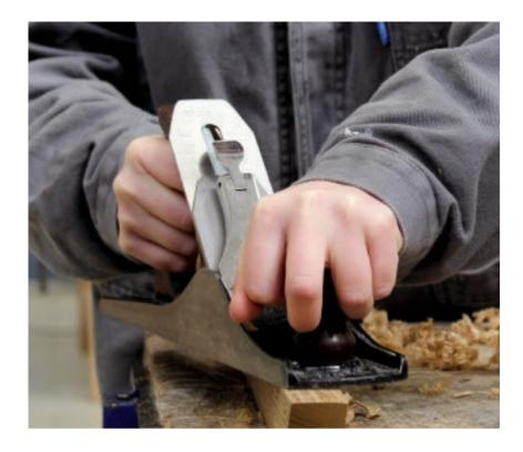
**Demi-varlope :** la demi-varlope est un rabot allongé utilisé pour dégauchir des pièces de bois.
