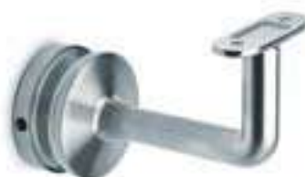
Flat handrail bracket for glass assembly, 8 - 12,76 mm Handlaufstütze flach für Glasmontage, 8 - 12,76 mm Support main-courante plate, fixation sur verre, 8 - 12,76 mm Vlakke leuninghouder voor montage op glas, 8 - 12,76 mm
