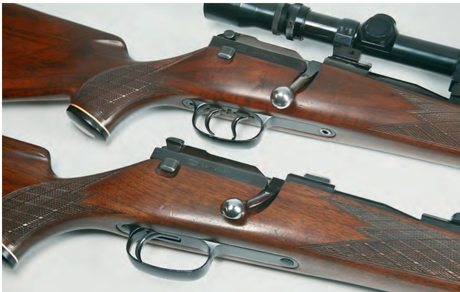
Der Kessler-Direktabzug (u.) der Mauser 66 steht ganz hinten im Abzugsbügel. Beim Doppelzügelstecher in der Originalversion (o.) gehts wesentlich enger zu.
