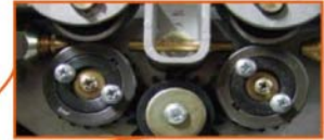
DOUBLE ROLL ทำให้ส่งลวดได้แม่นยำ สิ้นไหม แนวเชื่อมสวยงาม
