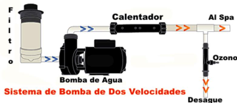
podrás ver cómo funciona. La bomba está conectada de tal manera que el agua entre en él a través del filtro, pasa por el calentador y luego vuelve a entrar en el spa a través de los chorros de masaje. Para la filtración y la calefacción se utiliza la baja velocidad de la bomba y cuando la gente está en el spa se utiliza la alta velocidad para el masaje. Como no es un sistema de
