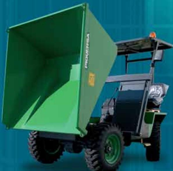
**Descarga Hidráulica Frontal
